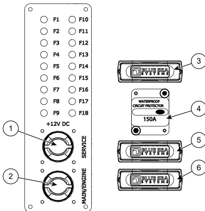
Abbildung 8.1 Buster Magnum/Cabin-Hauptschalter und -Sicherungspanel
