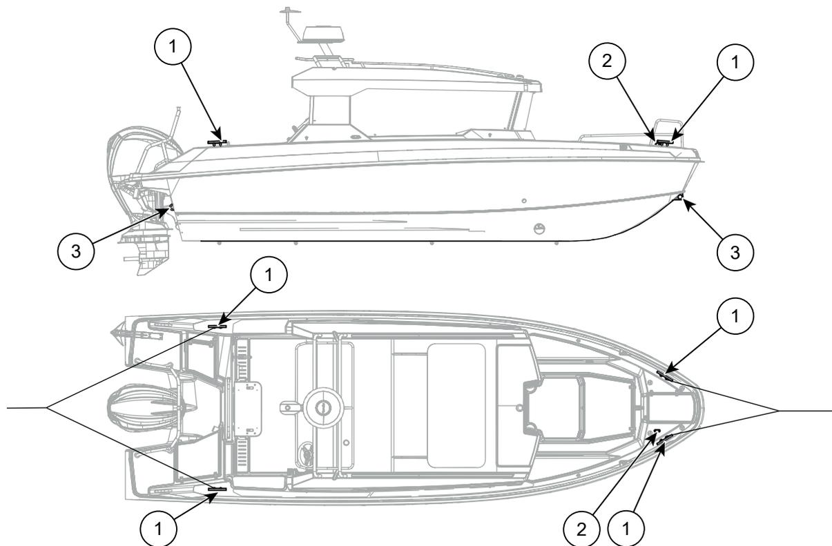
Abbildung 5.7 Buster Magnum/Cabin Befestigungs- und Schlepppunkte
