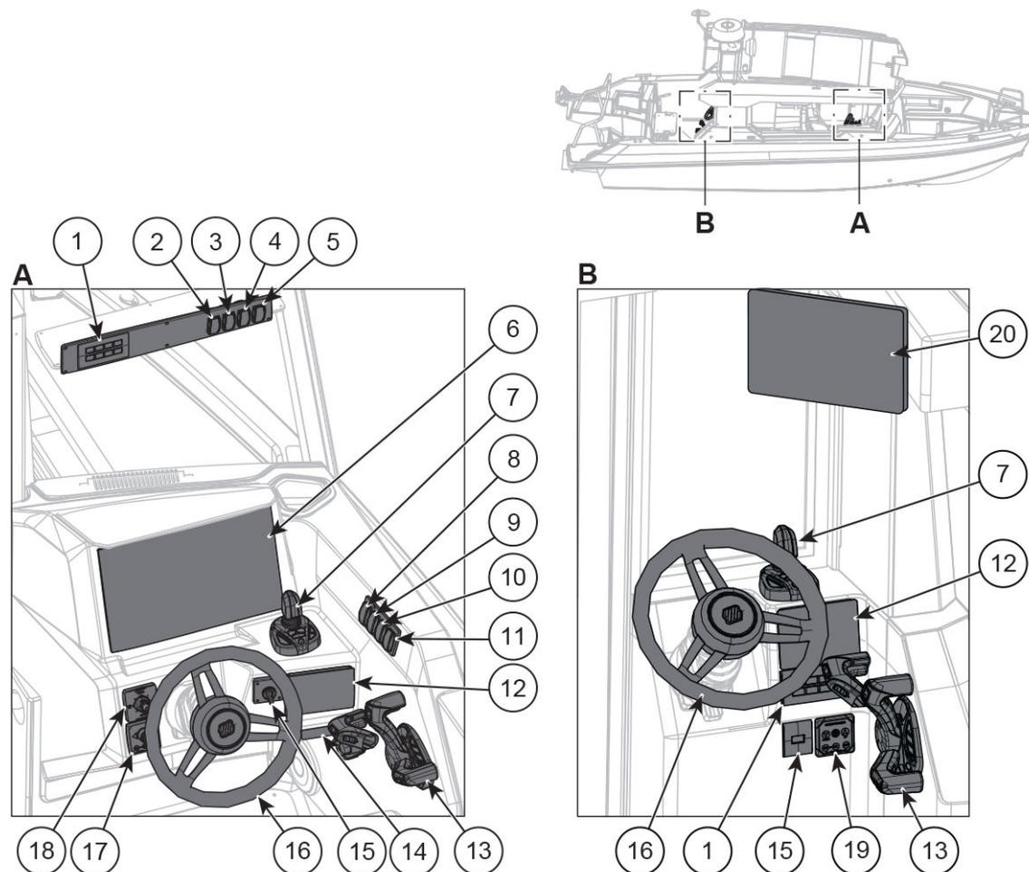
Abbildung 5.1 Bedienelemente am Steuerstand der Kabine (A) und optionale Bedienelemente am Außensteuerstand (B)
