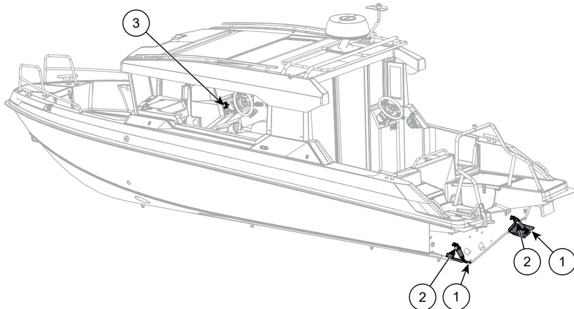
Abbildung 5.6 Position der Komponenten des Trimmsystems
